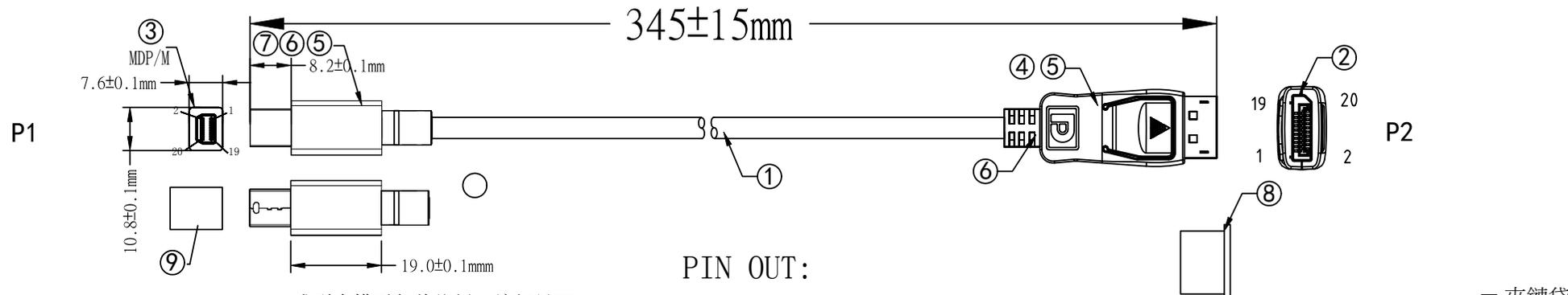
\*成型内模后包美纹纸，编织只可剪短不可剪少。包双面铜箔（编织包在铜箔内），再在铜箔正反两边点焊插头。
