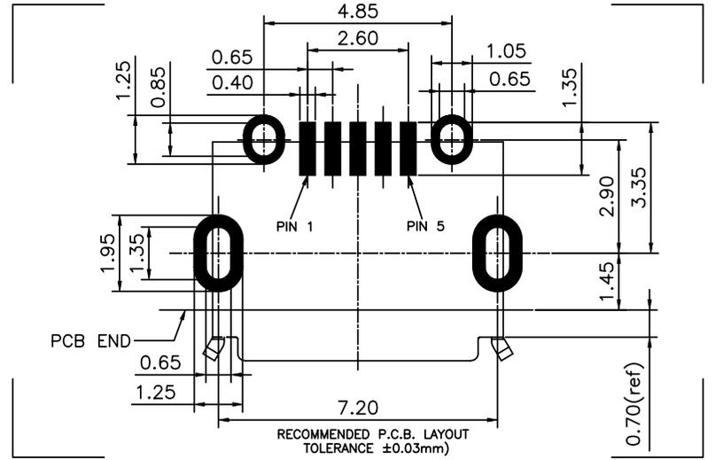
RECOMMENDED P.C.B. LAYOUT TOLERANCE ±0.03mm)
